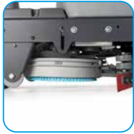
Peruuttaminen Kumilasta ja harjat vetäytyvät sisään peruuttamisen ja ajon aikana automaattisesti.
