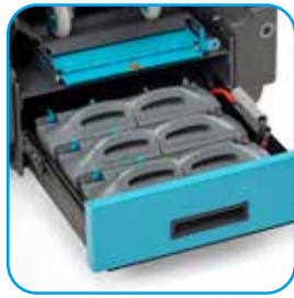
Liu'utettava akkulokero Akkutelineessä on tilaa kuudelle i-power 14 -akulle, mikä takaa jopa 80 minuutin käyttöajan. Vaihda akut vetämällä teline ulos ja liu'uttamalla akut pois. Akkuja vaihtamalla ja lataamalla käyttö on mahdollista ympäri vuorokauden.
