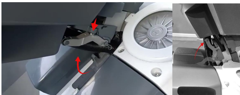
Figur 23c: För tillbaka enheten i läge innan den parkeras.
