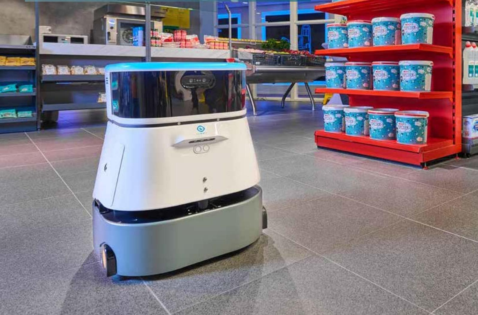
**Le co-botic™ 45 est une autolaveuse robotisée intelligente pour sols durs. La machine de nettoyage idéale pour les espaces de 200 m<sup>2</sup> à 1500 m<sup>2</sup>.**
