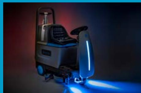
Für mehr Sicherheit laufen die Hinterräder auf dem trockenen Boden.
