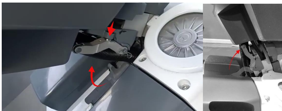
Rysunek 23c: Przywracanie pozycji przed zaparkowaniem urządzenia.
