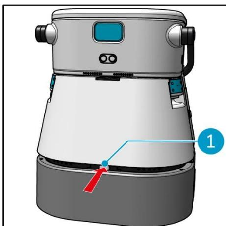
1. Presione el pestillo para desbloquear el depósito de agua limpia [1].
