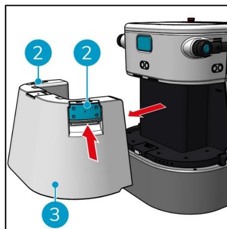
2. Presione el interior de las asas [2] y tire para extraer el depósito de agua limpia [3].
