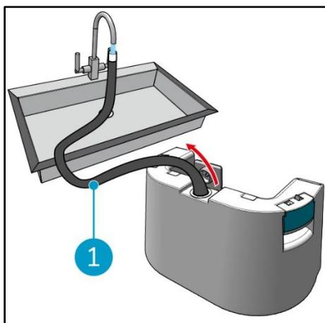
3. Utilizando la manguera interna [1], llene el depósito de agua limpia con agua limpia.
