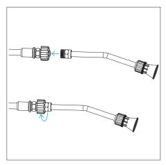
Paso 8 Conecte el tubo curvo a la junta roscada: sostenga el tubo curvo y apriete el tornillo con una llave de 22 mm.
