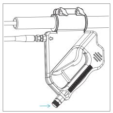
Conecte la entrada del control de potencia con la salida de la bomba y apriete el tornillo con una llave de 22 mm. Arranque la bomba y revise si hay fugas. Nota importante: utilice una manguera flexible de alta presión con un diámetro máximo de 13 mm.
