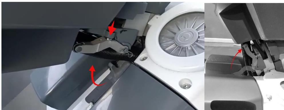
Figura 23c: riportare in posizione prima di parcheggiare l'unità.
