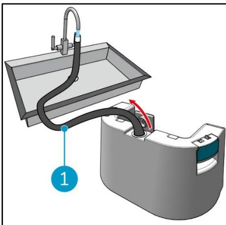
3. À l'aide du tuyau interne **[1]**, remplissez le réservoir d'eau propre avec de l'eau propre.
