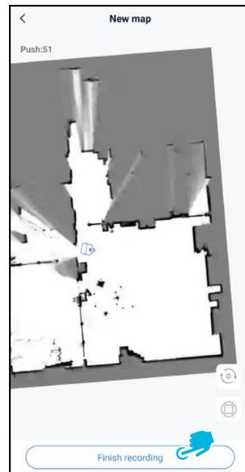
9. À l'aide du joystick, déplacez la cobotique 45 dans la pièce pour la cartographier. Sélectionnez **[Terminer l'enregistrement]** lorsque
