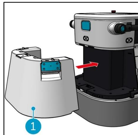
4. Insérez le réservoir d'eau propre **[1]**. Un déclic indique qu'il est correctement installé.
