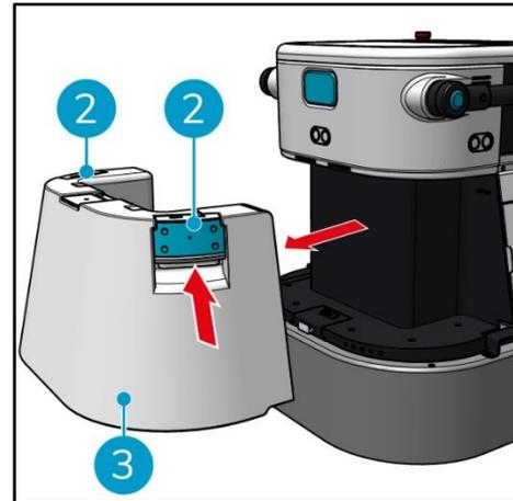
2. Appuyez sur l'intérieur des poignées **[2]** et tirez pour retirer le réservoir d'eau propre **[3]**.
